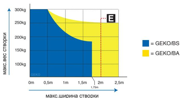
**ВНИМАНИЕ!** В случае, если длина створки более 2-х метров, или, если вы используете не самоблокирующиеся модели, должен быть установлен электрический замок, чтобы удерживать ворота в закрытом положении.
